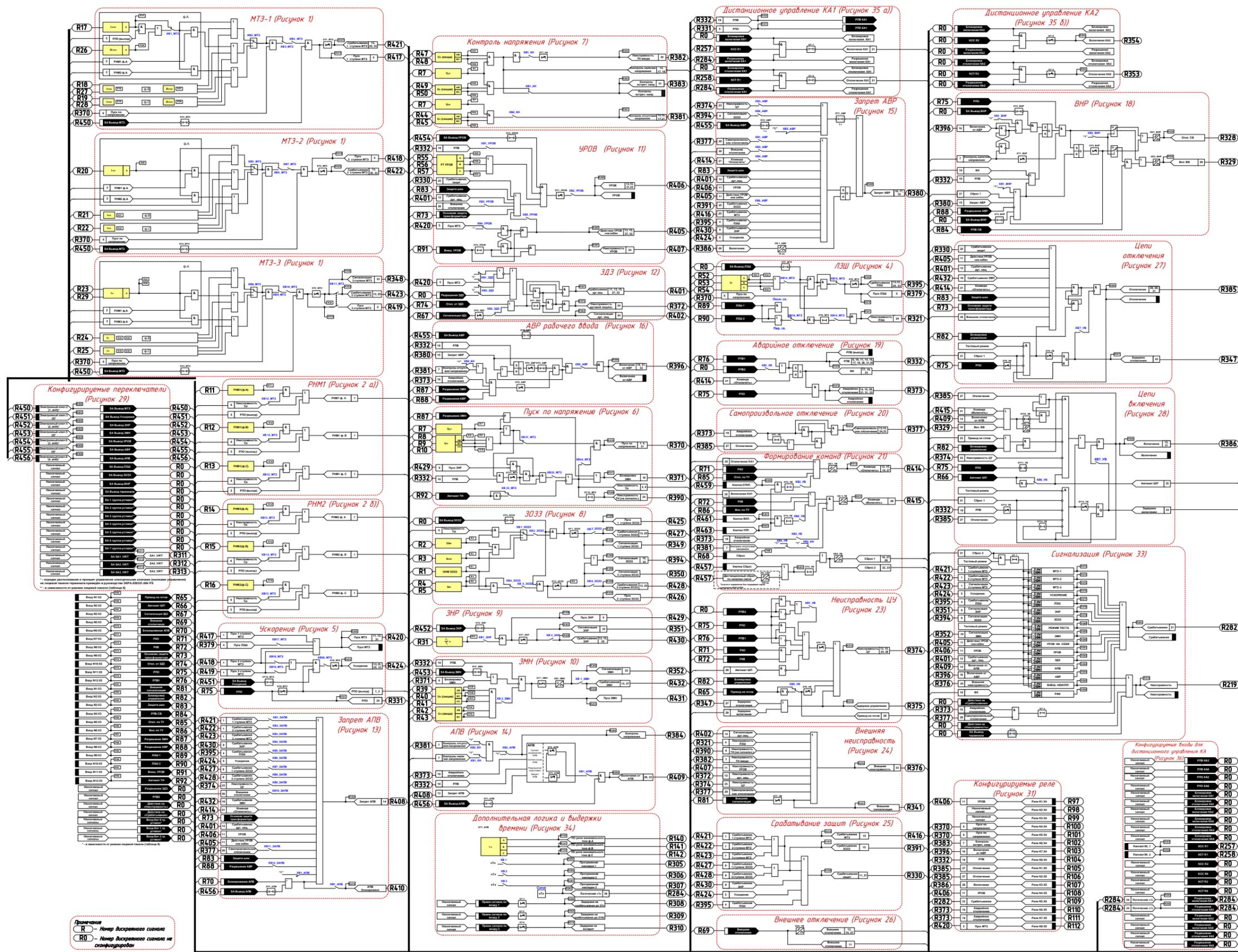
Рисунок 9 - Функциональная схема логической части терминала БЭ2502А0303
