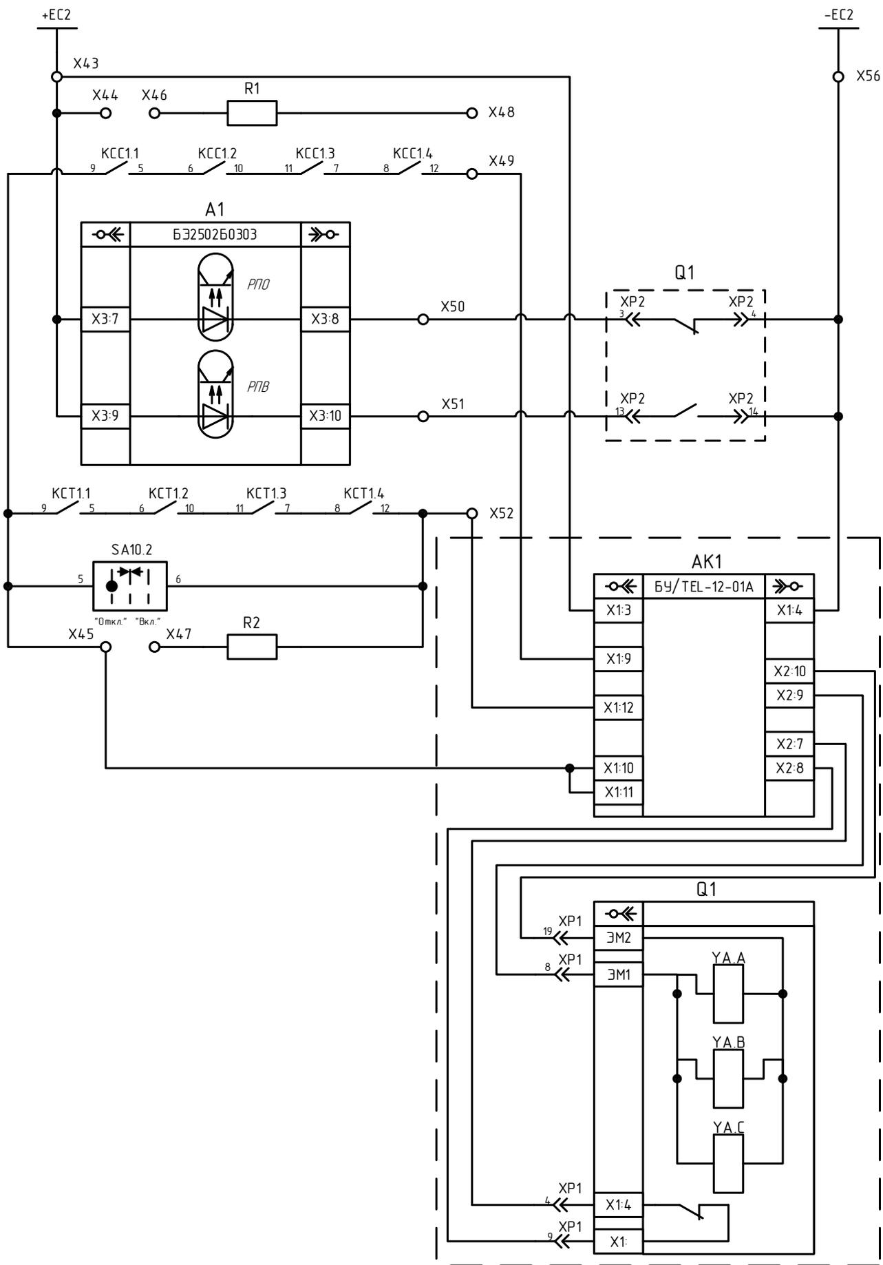
Рисунок 8 - Схема подключения выключателя ВВ/TEL-10
