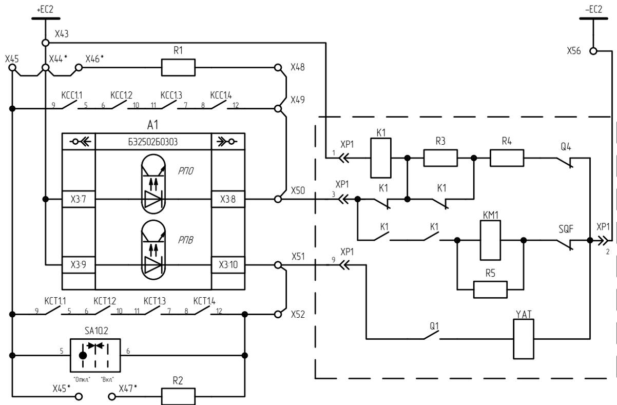
Рисунок 6 - Схема подключения выключателя ВВУ-СЭЦ-ЭЗ-10
