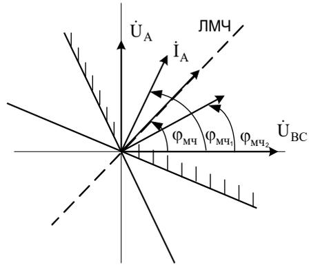
Рисунок 4 – Векторная диаграмма токов и напряжений, подаваемых на ИО направления мощности
