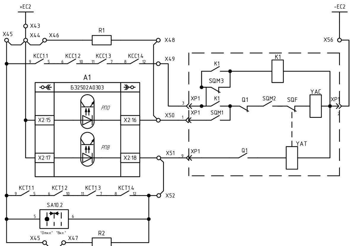
Рисунок 7 - Схема подключения выключателя ВВУ-СЭЦ-ПЗ-10 (ВБП-10-20, ВВЭ-М, ВБЭК)
